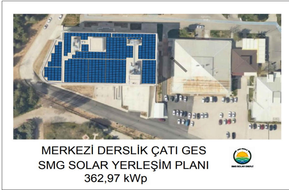
Şekil 2.14. Batı kampüsü merkezi derslikler çatısı GES yerleşim planı
